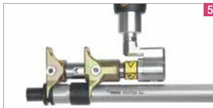
Sıxma başlığının yerləşdirilməsi
