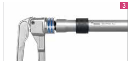
Boru ucunun enləndirilməsi
